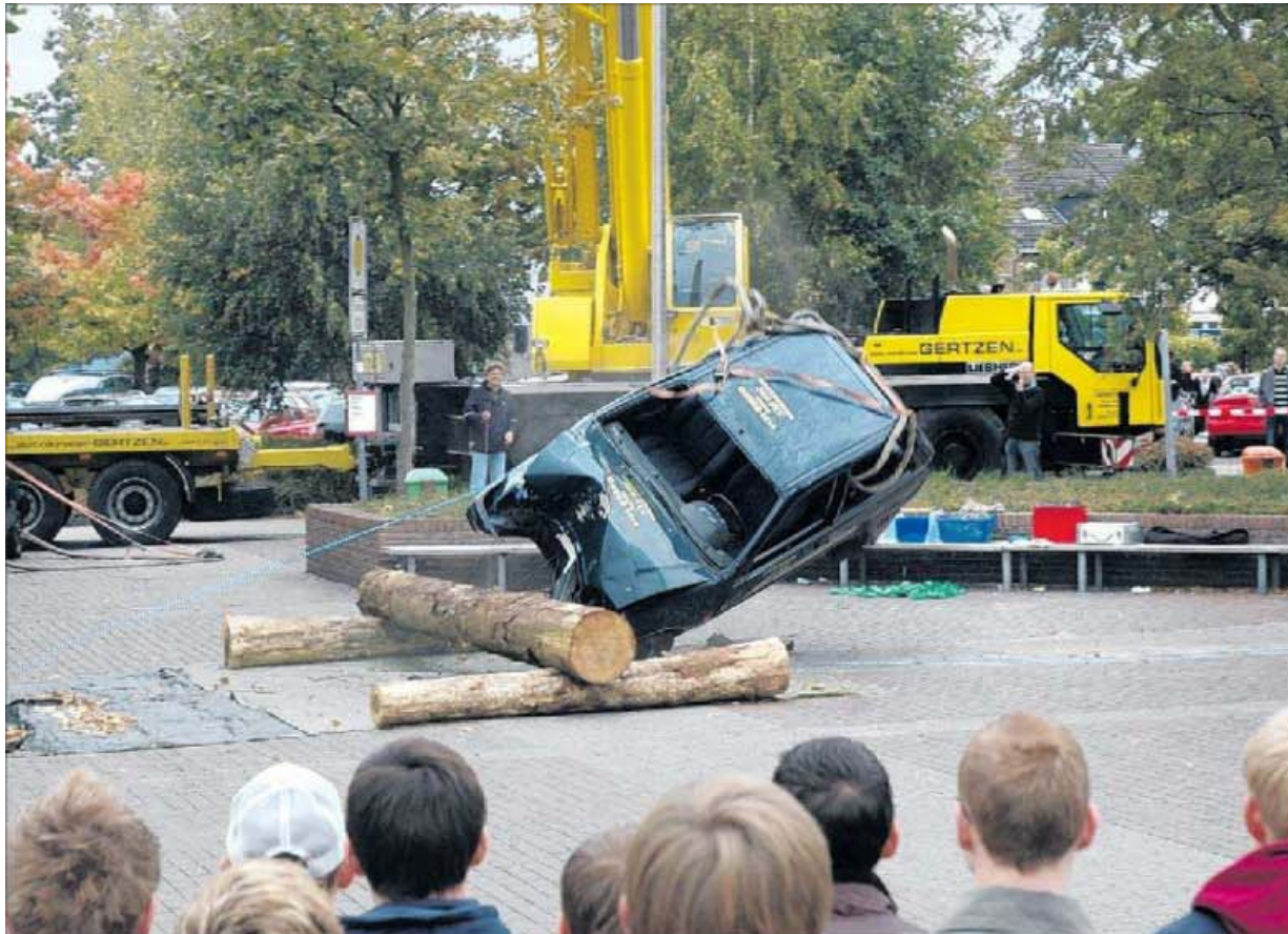
Durch den Aufprall auf den Baumstamm hat sich der gesamte vordere Teil dieses Wagens verbogen. Der Test sollte die enorme Kraft, die auf ein Auto im Falle eines Unfalls wirkt, darstellen.
